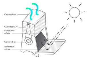
Modulare, con 7 ripiani intercambiabili (alto, basso) per ogni tipo di alimento, OMY utilizza l'energia solare. Il riflettore a specchio con inclinazione regolabile è posizionato nella parte inferiore dell'essiccatore per accelerare l'irraggiamento che viene diretto verso la lastra nera "l'assorbitore solare", situata all'interno dell'essiccatoio. La lastra nera assorbe la radiazione solare e la converte in calore.
