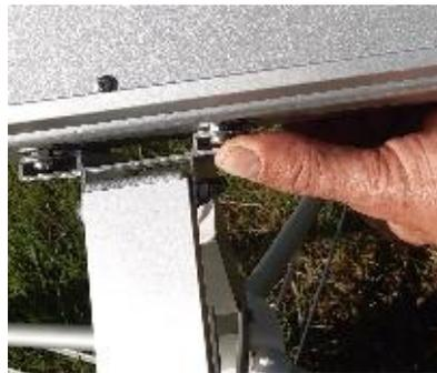
Pour retirer le SUNCHEF après utilisation, placez simplement votre pouce sur le dessus de la douille et vos quatre autres doigts en bas du SUNCHEF et poussez en tenant la poignée en même temps, jusqu'à libération complète. **N'oubliez pas de desserrer les deux écrous à oreilles à droite et à gauche lors de la fermeture.**
