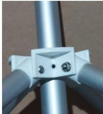
6. Remettez en place l'écrou et la vis, et vissez-les avec le tournevis. Attention, si les trous sont bien alignés vous ne devriez pas avoir à forcer pour visser.
