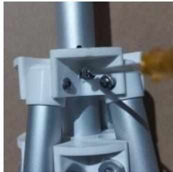
5. Poussez le tube pour aligner le trou du tube avec celui du plastique.
