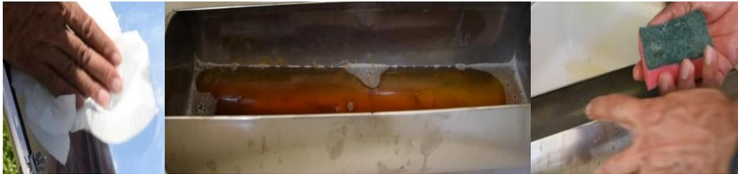
Pour nettoyer les miroirs lorsqu'ils sont poussiéreux, utilisez toujours du papier absorbant humide avec de l'alcool ou un nettoyant pour vitres. Évitez l'utilisation de tissus préimprégnés de type lingettes. Ne nettoyez jamais le tube en pyrex lorsqu'il est chaud, seulement lorsqu'il est à température ambiante.
